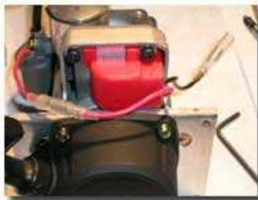
Jetzt werden die acht (8) Schrauben entfernt, mit denen der Kühlkopf an dem neuen Zylinder befestigt ist. Entferne den Kühlkopf und den Zylinderkopf. Jetzt hast Du Zugang, um mit den vier (4) mitgelieferten Schrauben den J&G Zylinder am Zenoah-Gehäuse zu befestigen.
