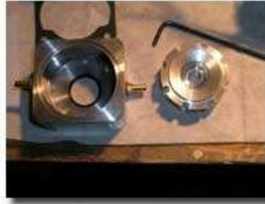
Jetzt kannst Du den J&G Zylinder auf dem Kurbelgehäuse montieren. Ersetze die Standard-Fußdichtung durch die mitgelieferte Fußdichtung. Ziehe die Befestigungsschrauben für den Zylinderfuß mit einem Drehmomentschlüssel an (42 inch pounds). Setze den Zylinderkopf auf den Zylinder, achte dabei darauf, dass die Schlitz mit den Löchern für die Befestigungsschrauben übereinander passen. Installiere den Kühkopf (O-Ringe nicht vergessen) und befestige ihn mit den acht (8) mitgelieferten Schrauben.
