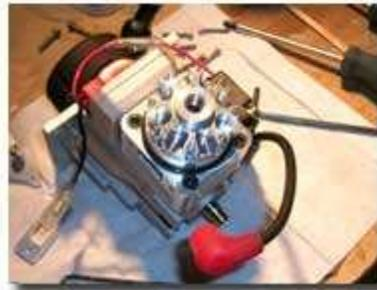
Entferne die zwei (2) oberen Befestigungsschrauben des Seilzugstarters. Installiere den mitgelieferten Zündspulhalter mit diesen two (2) Schrauben vor dem Starter. Entferne die graue Zündspule vom ihren Originalplatz und montiere sie an dem neuen Halter. Die dafür erforderlichen Schrauben und Abstandsscheiben sind mitgeliefert.
