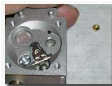
Wenn man sich dafür entscheidet, das Kapillarsieb zu reinigen, dann sollte man beim Wiedereinbau des Stopfens diesen nicht zu weit eindrücken, da man sonst die Zuleitungsbohrung für den Sprit versperrt. Stelle sicher, dass Du Dir den richtigen Sitz des Stopfens merkst, BEVOR Du ihn ausbaust, damit Du hinterher noch weißt, wie weit man ihn reindrücken muss.
