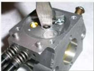
Wenn man das Nadelventil wieder einsetzt, sollte man die Steuerhebel-Justage prüfen. Von Walbro gibt es dafür eine Einstelllehre (Teilenummer: 500-13). Man bekommt aber auch eine wirklich gute Einstellung hin, in dem man einfach einen flachen Schraubendreher oder ein Lineal über die schmalen Kanten und die Spitze des Hebelarms legt. Die Spitze des Hebels sollte dann gerade eben den Schraubendreher berühren
