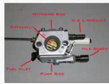
Ist der Vergaser verschmutzt, dann solltest Du ihn reinigen, bevor Du ihn auseinander nimmst. Pressluft und Bremsenreiniger oder Methanol eignen sich sehr gut dafür. Wenn ich in diesem Artikel davon spreche, Pressluft zu verwenden, dann sollte man das immer sehr vorsichtig tun. Niemals direkt in die Öffnungen mit hohem Druck reinpusten, das ist nicht erforderlich.
