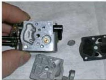
Kommen wir zu der Sprit-Zufluss-Seite des Vergasers ... Auf dieser Seite wird die Abdeckplatte mit 4 Schrauben befestigt. Das kann eine einfache Platte sein
