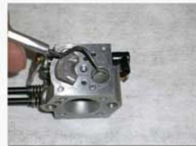
Hier kann man schön sehen, dass bei diesem Vergaser der Filter leicht verschmutzt ist. In dem unteren Bild sieht man das Vergasergehäuse mit entferntem Filtersieb. Noch mal, reinige alles gründlich, schau Dir auch die Unterseite der Abdeckplatte an. Hier siehst Du eine „Versteifungsrippe“ entlang der Kante. Diese wird für eine gute Abdichtung benötigt und sollte nicht beschädigt sein.
